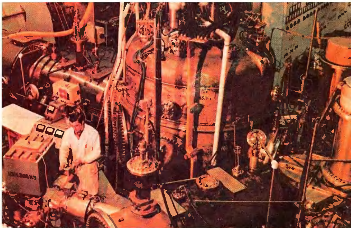
Рис. 7. Установки «Токамак» — не единственный тип устройств, на основе которых ученые надеются создать термоядерный реактор. Другой тип термоядерных установок — ловушки с магнитными пробками. Частицы плазмы удерживаются в них благодаря отражению от «магнитных зеркал» — областей с повышенной индукцией поля, в которых происходит сжатие силовых линий. На рисунке представлена одна из таких установок «Огра-3Б».
